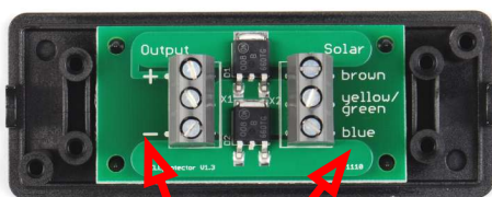
Farbkodierung für die Anschluß-Leitungen
