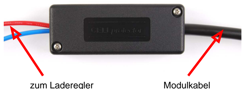
Zellprotector fertig montiert
